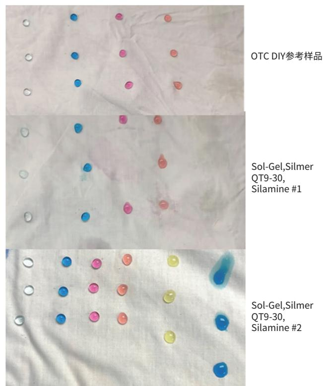
图9 ❖ 经有机硅处理后的灌浆塞的耐油性。
