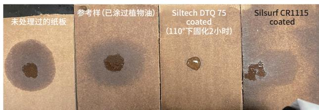
图 13 ❖ Silmer DTQ-75处理过的纸板。
